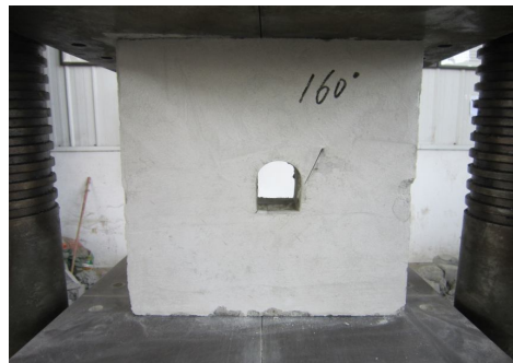
图2 带裂纹隧道的试验模型
